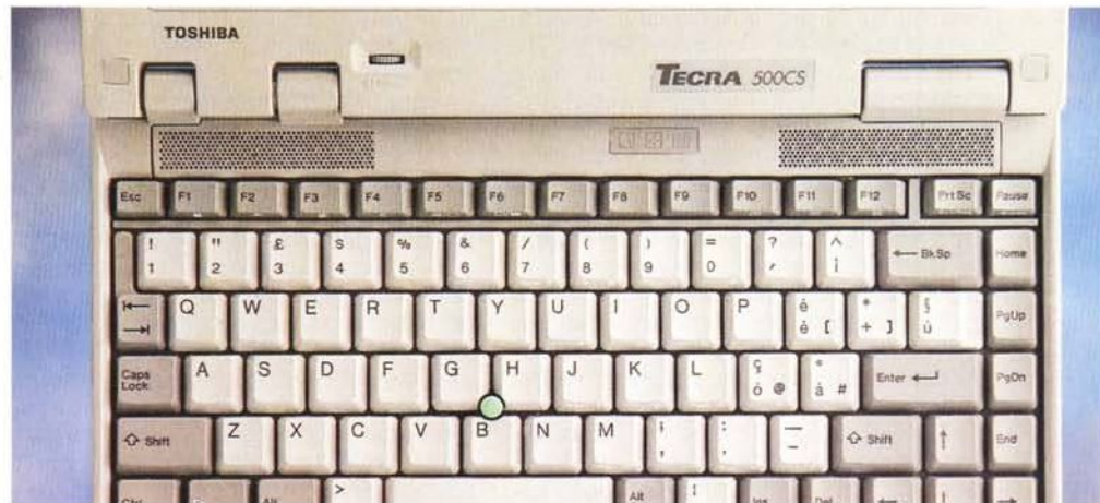
Il dispositivo di puntamento è l'ormai noto MousePoint inventato da IBM. A destra la tastiera, completa e ben funzionante.
